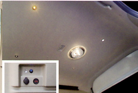
室内灯 (LED+スポット 5 灯) / スイッチ・電圧計
