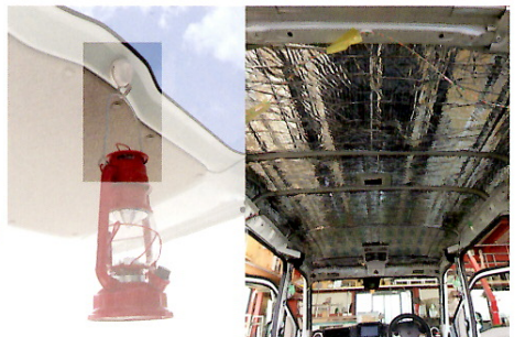
リヤゲートフック (マグネット) 防音・断熱加工 (天井)
